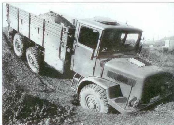
15. listopadu 1951 armáda přebírá Tatru 130. Součástí přejímky byly zkoušky na silnici i v terénu v Beskydech. Jízdní vlastnosti vojenskou správu uspokojily. Další zkoušky potvrdily, že (ne)spolehlivost odpovídá menší Tatře 128
