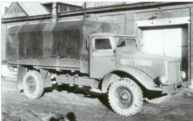
Prototyp Tatra V877 měl zajistit poválečnou motorizaci armády. Tento prototyp byl interně označován jako „zástavba motoru V966 do Fordu-Canada“. Takové řešení však v prosinci roku 1949 již nepřicházelo v úvahu. Byl jen zčásti, přebírá tato Tatra tehdejší tvář kopřivnických „nákladáků“
