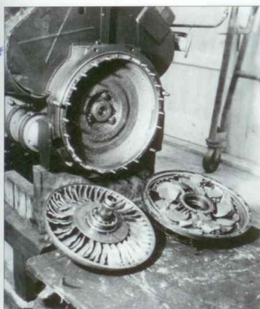
V Tatře 128 byla též zkoušena kapalinová spojka původní kopřivnické konstrukce. Zde demontovaná po poškození
